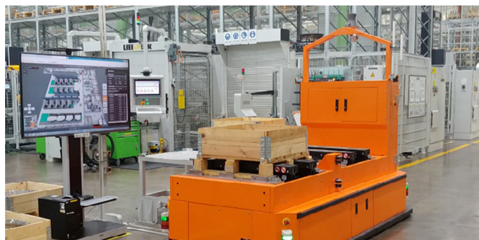
韩华航空昌源工厂车间里的自动导引车（AGV）将发动机部件送到指定工作站
